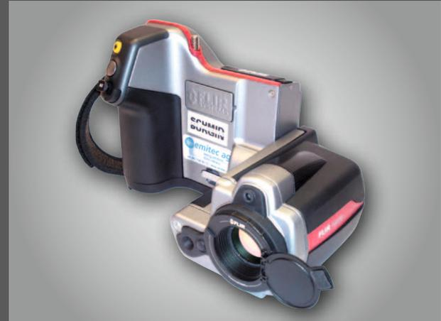
*Mit unserer FLIR Infrarot-Kamera erstellen wir Thermografie-Bilder, die Differenzen in der Wärmeabstrahlung von  $\pm 0.08$  °C darstellen können.*
